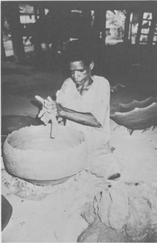
Fig. 4. — Verstevigingsproces voor de wand van de vuurschotel, Aibom.
